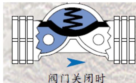
当压力介质(水等)进入阀门控制腔,隔膜下压,关闭阀门通道,当控制腔压力排向大气或下游管道,隔膜上升,阀门通道被打开。
